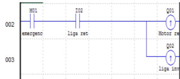
Figura 10: Linha do programa para o reset do botão emergência
